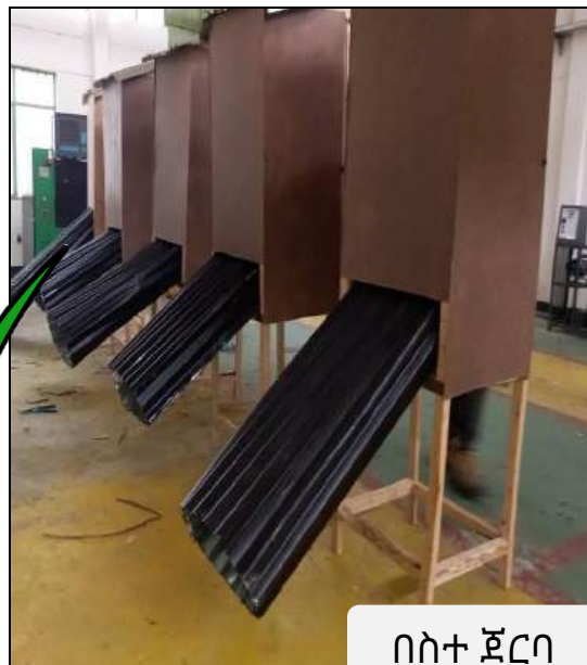
ምስል 18: በሐረማያ ዩኒቨርሲቲ የተሰራ የለውዝ ማድረቅያ ማሽን
