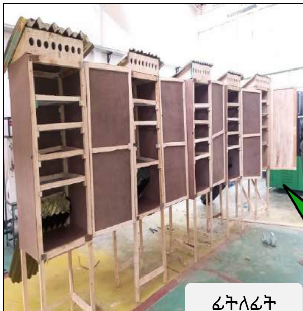
ምስል 18: በሐረማያ ዩኒቨርሲቲ የተሰራ የለውዝ ማድረቅያ ማሽን
