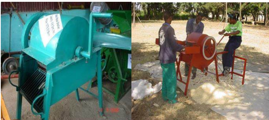
ምስል 22. በአነስተኛ ሞተር ሃይል ወይም በትራክተር ፒ.ቲ.አ. ሻፍት (በግራ) እና በፔዳል (በቀኝ) የሚሠሩ የበቆሎ መፈልፈያዎች
