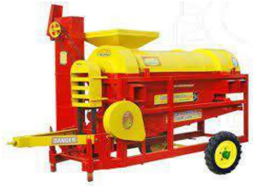
ምስል 23. በአነስተኛ ሞተር የሚሰራ የህንድሥሪት የበቆሎ መሸልቀቂያ መውቂያ (ኦብሴ) ባለሞተር የበቆሎ መፈልፈያ ማሽን (Motorized maize/Corn DE husker) ስለአጠቃቅሙ ካምባኒው የሚያውጣውን ማንዋል ማየት ያስፈልጋል።
