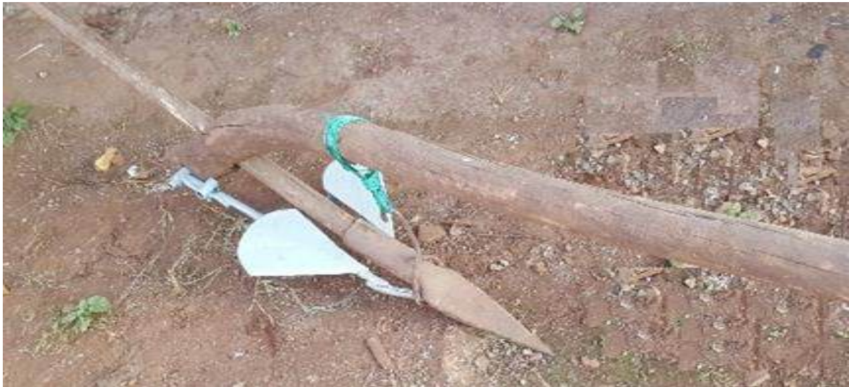
ምስል 9: በባህላዊው ማረሻ ላይ የተገጠመው አዲስ አይባር ቢቢኤም ቀላል መሳሪያ
