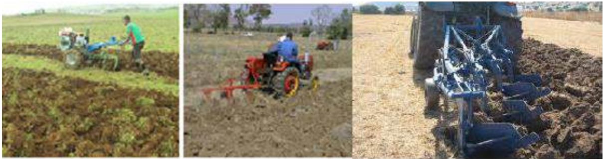
ምስል 7: በትራክተር ላይ ተገጥመው የሚሰሩ የገልባጭ ማረሻ አይነቶች
